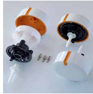
Drehwahlschalter Baugruppe vollautomatisch montiert, bestehend aus Drehschalter- kappe (ASA/ABS), Lagerung (PBT), Achse (PBT), Kulis- se (POM) und Federhülsen
