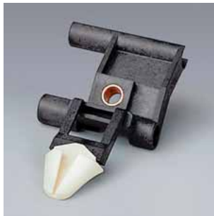
Fadenleiteinheit als Verschleißschutz und Trägerelement. Material: Polyamid / Keramik / Metall-Buchse
