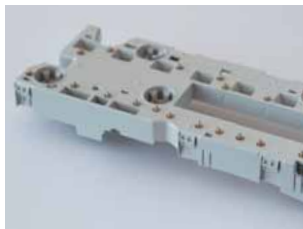
Gehäuse (Polycarbonat/ABS mit Flammenschutz) für Elektronik Steuerplatine mit umspritzten Metallspiralfedern für Sensortouch-Bedienfelder
