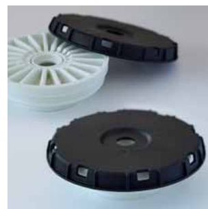
Kappe bestehend aus Grundteil und Deckel (PA6.6 glasfaserverstärkt) ultraschallverschweißt zur Aufnahme Rollball für Luftfederung
