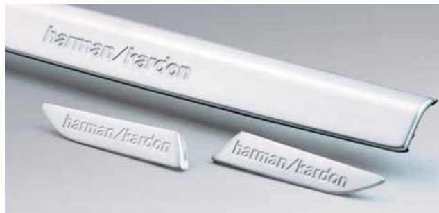
Im Inmold-Dekorationsverfahren hergestellte Lautsprecherblende. Material: PPO/IMD-Dekorfolie
