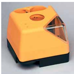
Steuerungsgehäuse aus Polyamid mit eingespritztem Sichtfenster aus Polycarbonat für Laser-Nivelliergerät (Gewicht ca. 150 g); Verzug minimiert durch Material-Mix: Glasfaser-Glaskugel
