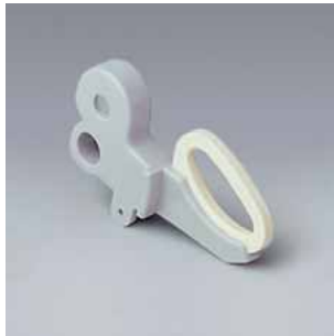
Fadenführer mit Halterung als verschleißfestes Element in Textilmaschinen. Material: glasfaserverstärktes PA6 / Keramik
