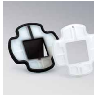
Komplette Gemischklappe für Gasgebläsebrenner in Heizungsanlagen, bestehend aus 2-Komponenten-Grund- platte (Polyamid) mit Dichtung (TPE) montiert mit Außen- dichtung (Viton) und Schwing- klappe (Polyamid mit 80% Kupferanteil)
