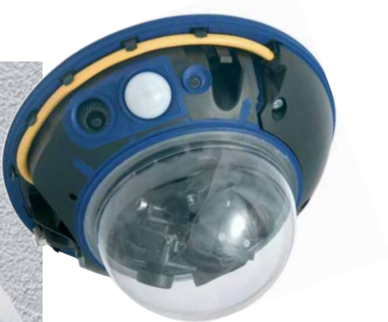
Gehäuse-Grundkörper mit umspritzter TPE-Dichtung und montierten Metall-Gewindebuchsen für Video-Überwachungskamera. Darstellung zeigt komplette Kamera incl. Wandhalter. Material: PBT
