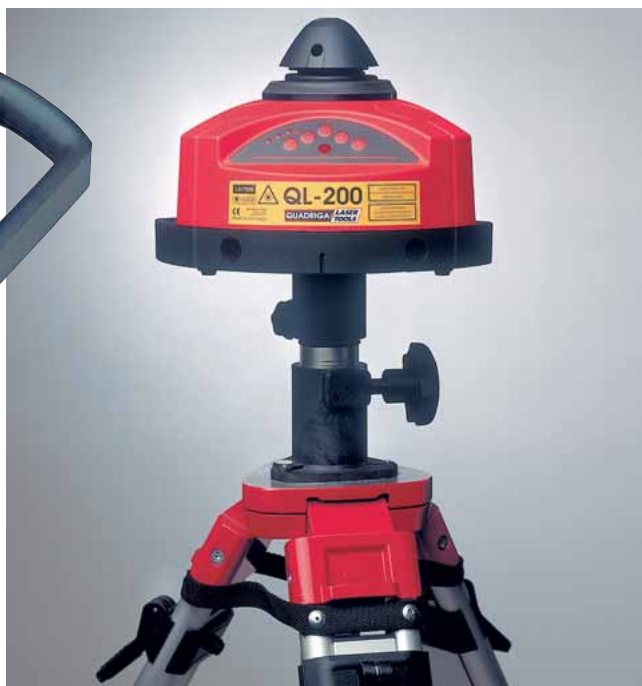
Kompletter Rotorkopf für Laser-Nivelliergerät bestehend aus Grundplatte und Gehäuse (Polyamid) mit 7 Metall-einlege-teilen und Bedruckung; Gewicht ca. 460 g
